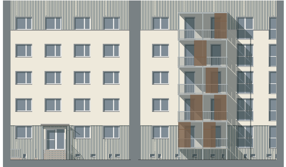
Drei statt zwei Balkonanlagen wird es künftig an dem Neubaublock geben. Der Ausschnitt zeigt die verschiebbaren Sonnenschutzelemente. Das Objekt besteht auch künftig aus drei zusammenhängenden Häusern mit separaten Treppenaufgängen.
